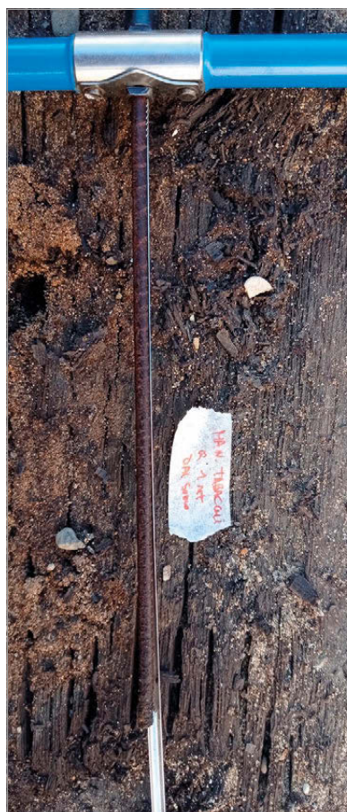
Fig. 5 – Firenze. Una delle carote sull'estrattore. Gli anelli di accrescimento sono ben visibili (foto N. Macchioni).
