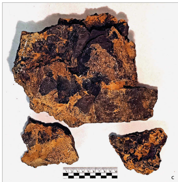
fig. 101 – Laterizi caratterizzati da annerimenti superficiali (a) e da distorsione della forma (b); blocco informe di argilla alterato dalle alte temperature (c); elemento a configurazione triangolare con profilo arrotondato (d).
